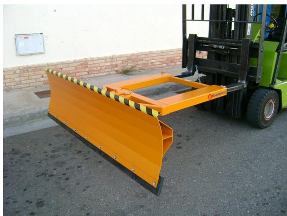
**Pala quita nieve de goma. Fabricada con perfiles de acero para proporcionar una estructura robusta y resistente. Medidas 2.000 mm de largo x 500 mm de alto. Peso 170 KG, ANGULO DE GIRO 30°.**
