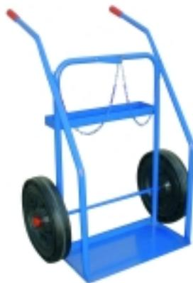
Carro perfecto para el transporte de dos botellas de soldadura, posee ruedas de goma maciza de Ø 380. Cajón para boquillas. Construido en tubo de acero muy resistente y capaz de soportar cargas hasta 280Kg. Hueco útil 550x290
