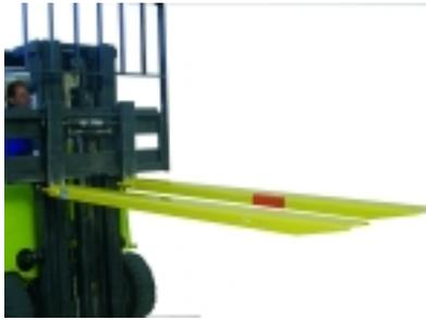
Uñas de carretilla, la mejor solución para mejorar la seguridad y las prestaciones de una carretilla. Ancho exterior 130 . Fabricadas en acero muy resistente. (Indicar medidas de las uñas y largura necesaria).
